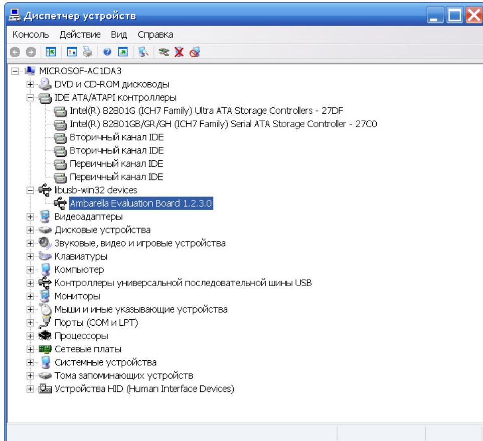
11. Если устройство определилось в диспетчере устройств (в независимости установились драйвера или нет), можно отпустить кнопку REC.
