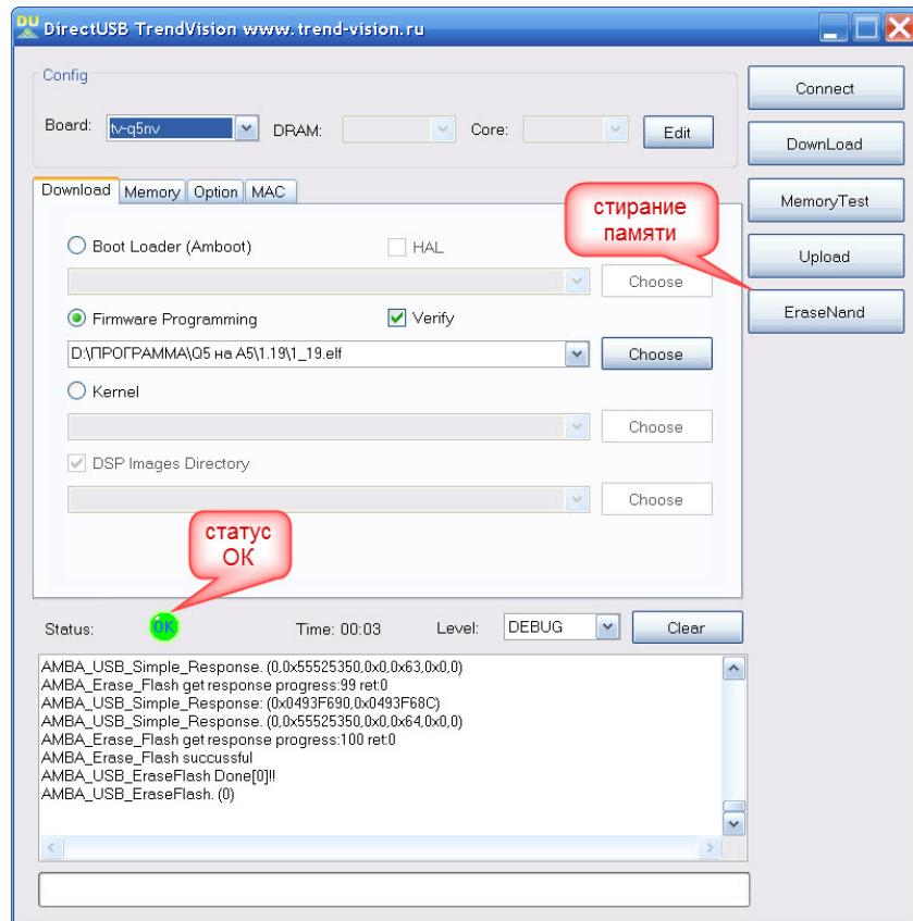
21. Для загрузки прошивки необходимо нажать на кнопку **DownLoad**. В случае успешной установки прошивки индикатор **Status:OK** и окрасится в зеленый цвет.
